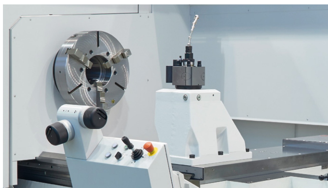
带快换刀座的加工区域
