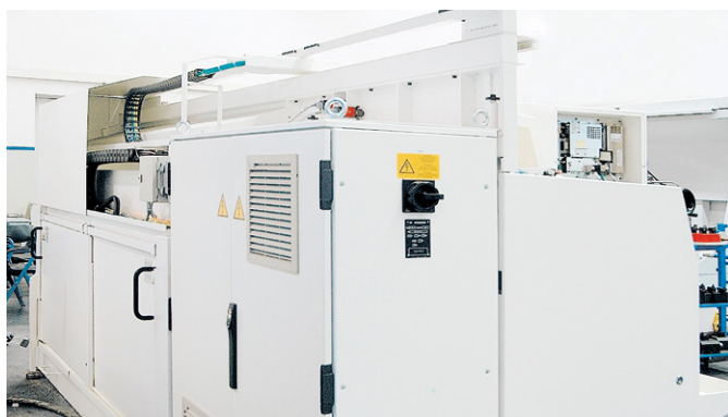
为了增加维护机床的接近性，全部电源系统布置在加工区域外面
